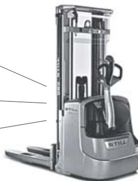
Avantage unique du gerbeur à conducteur accompagnant EXV avec timon exclusif intégrant la technologie OPTISPEED : l'adaptation automatique de sa vitesse de circulation en fonction de la distance séparant l'opérateur du chariot. Les commandes intégrées au timon suivent le même niveau d'excellence : adaptées aux droitiers comme aux gauchers, le conducteur peut les utiliser sans avoir à détourner les yeux : différenciation sensitive des commandes pour une reconnaissance de chaque fonction.
