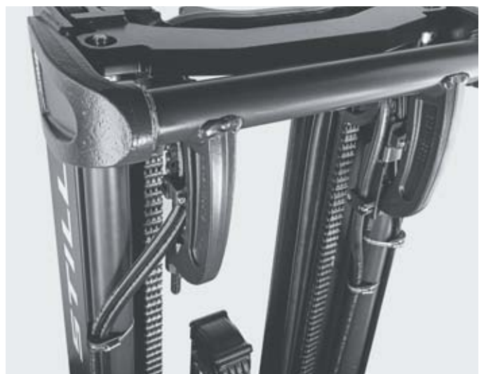
Traverse stable offrant une visibilité optimisée
