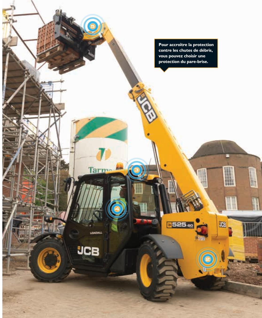
Pour une excellente visibilité et une sécurité optimale, le TELESCOPIC 525-60 Hi Viz est équipé d'un jeu complet de rétroviseurs latéraux.
