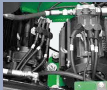
Traction et levage adoptent des moteurs synchrones à aimants permanents grâce au contrôleur Enpower.
