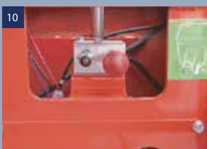
Soupape de décharge manuelle : Lorsque la nacelle ne peut plus bouger, il est possible de la pousser après avoir actionné cette soupape.
