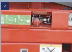
Soupape manuelle d'abaissement : En cas de panne du système de commande ou de batterie déchargée empêchant la plateforme de descendre, cette soupape permet de faire descendre la nacelle.
