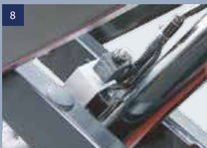
Vanne antidéflagrante : Empêche la chute de la nacelle en cas de fuite d'huile
