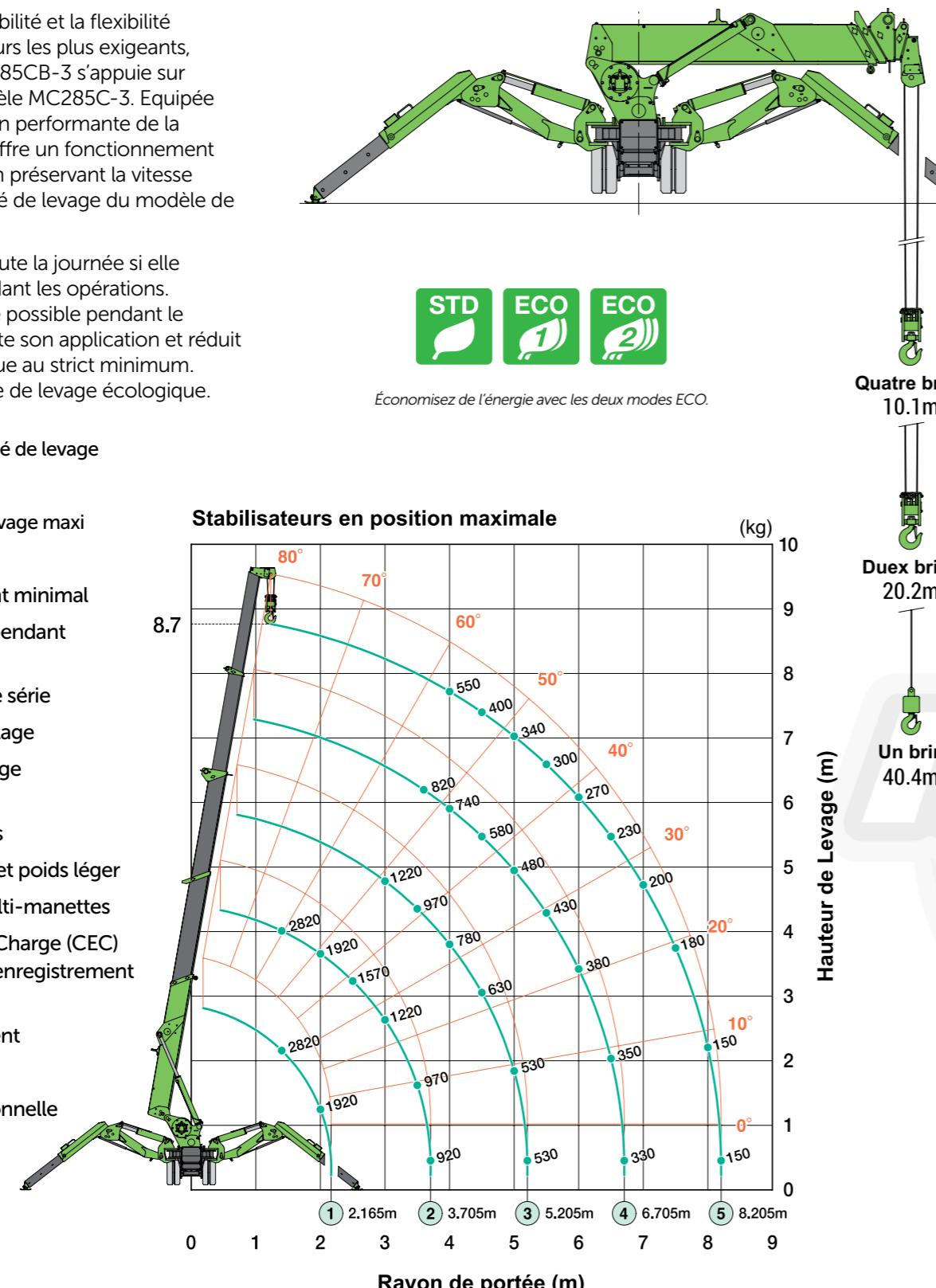
Le diagramme de portée montre la charge nominale totale, incluant la déformation de la flèche.
