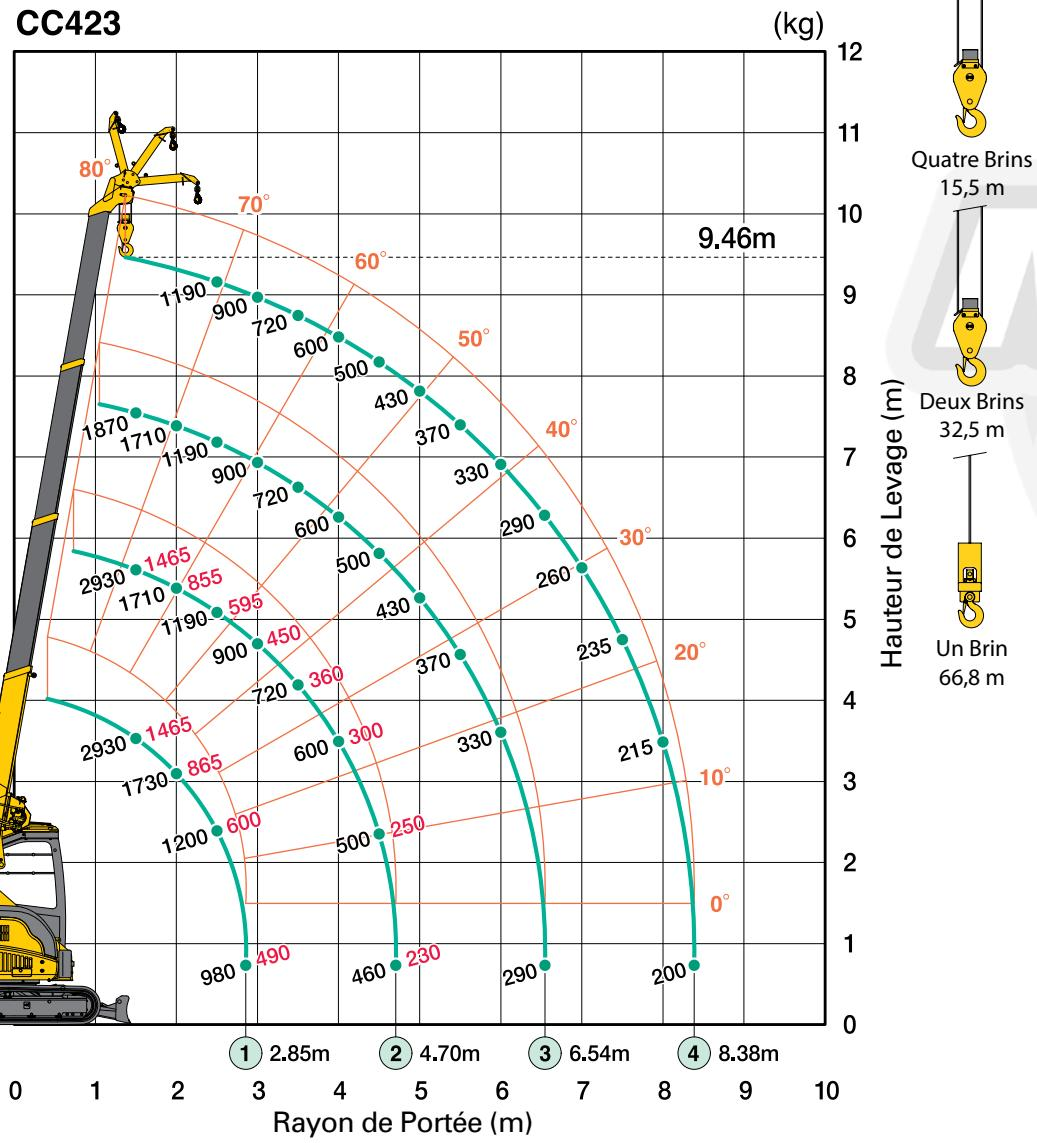
Le diagramme de portée montre la charge nominale totale, incluant la déformation de la flèche.
